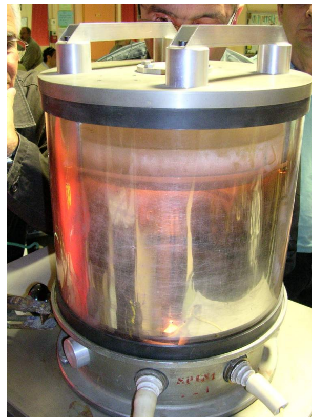
La métallisation du miroir de 260mm progresse (cliché Jacques GISPERT)
