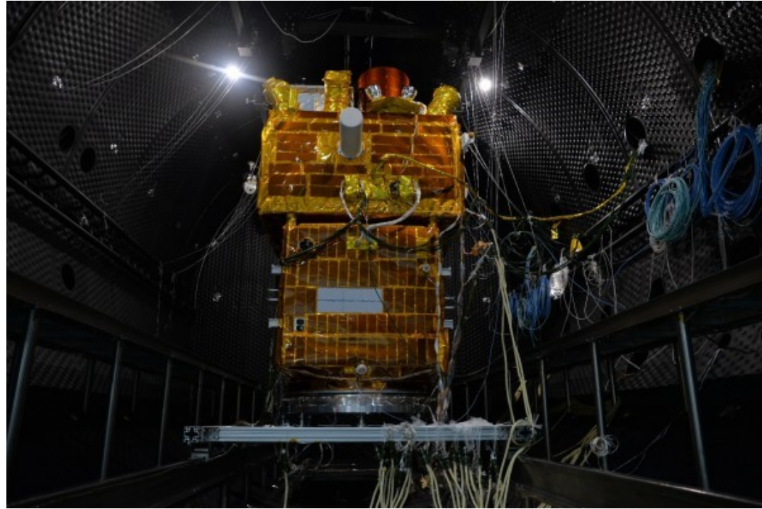
Le modèle de qualification du satellite SVOM à Shanghai pendant les essais en vide thermique, octobre 2019, crédit SECM.
